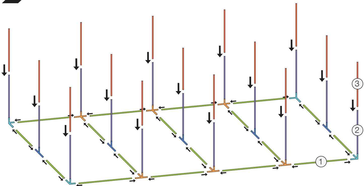
Assembler la partie inférieure du châssis, comme indiqué à l'aide des trente connecteurs d'angle et des tiges 1,2,3 en vous assurant que les tiges soient bien insérées dans les connecteurs d'angle.
