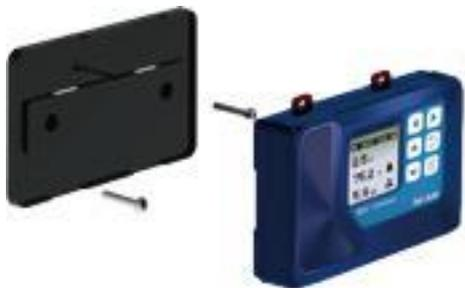
Déterminez où localiser le contrôleur principal. Le contrôleur est livré avec un support de type DIN simple à utiliser. Tirez les 4 languettes vers l'extérieur pour dégager le support de l'appareil, montez le support sur un mur ou une surface, remplacez l'appareil sur le support et appuyez sur les 4 languettes pour verrouiller l'appareil en place.
